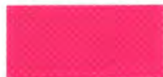
3663FP 透光率 23% opera pink オペラピンク Munsell value(マンセル値) (H)0.16R(V)4.97(C)14.45
